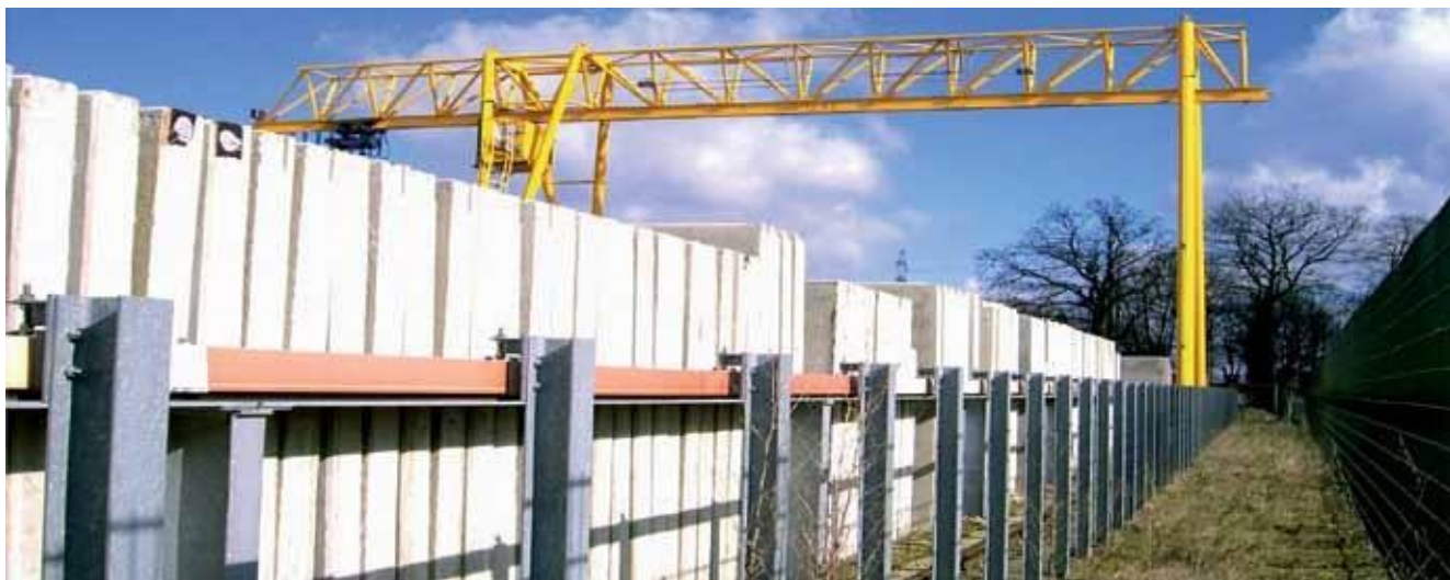
Токоподвод длиной 120 метров для подачи электроэнергии на мостовые краны на производстве ж-б конструкций
