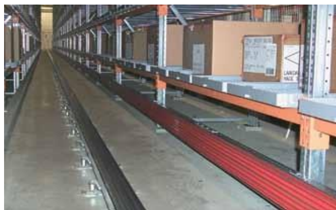
Использование системы «Продактор» для подачи электроэнергии на высокоскоростное складское оборудование
